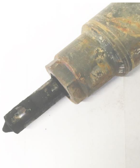
Vstřikovač před testem
