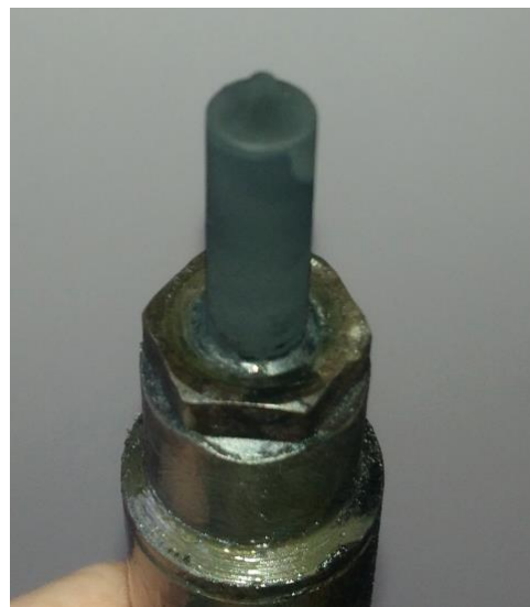
Vstřikovač po testu
